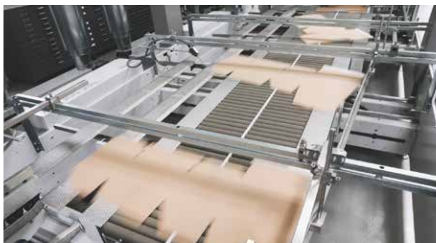
Rozwiązanie Gyrobox umożliwia produkcję kompleksowego opakowania typu e-commerce w jednym przebiegu, dzięki możliwości obrócenia użytku w przedziale od 0 do 180 stopni w każdym kierunku.
